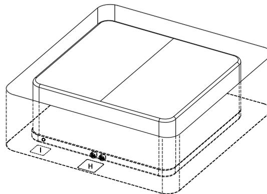
**A : Hauteur dalle béton >100mm**
