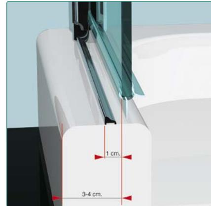
Installation et encombrement du brise-flux
