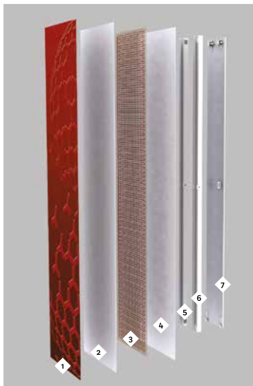
1 - Finition Avant | 2 - Composant polymère 3 - Câble chauffant électrique | 4 - Composant polymère 5 - Structure support | 6 - Caches latéraux 7 - Plaque de fixation réfractaire
