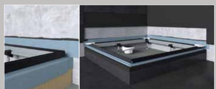
Als de douche iets verhoogd moet worden ingebouwd, worden de hulpstukken voor bekleding aan de wandzijde zijdelings aan het frame, en aan de zijkanten die later betegeld moeten worden van onderen gemonteerd. Nadat het frame is gefixeerd en op definitieve hoogte is uitgelijnd worden de bekledingspanelen bevestigd.
