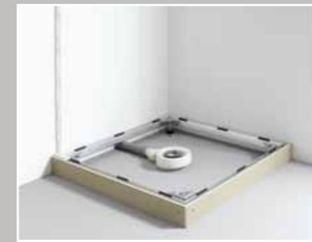
Het inbouwframe wordt traploos afgesteld, op de ruwe bouvloer geplaatst en vastgezet. De meegeleverde bekistingshulp wordt aangebracht.
