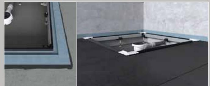
Voor een inbouw als inloopdouche worden de vier meegeleverde bekledingshulpstukken omlopend aangebracht. Vervolgens wordt het systeem uitgelijnd en de bekledingspanelen bevestigd. Daarna wordt de smeenvloer aangebracht.
