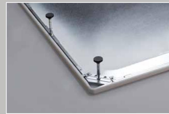
Het **BETTEPOTEN-SYSTEEM** garandeert een snelle, veilige en voordelige hoogteinstelling bij de inbouw van douchebakken en douchevloeren. Hiervoor wordt er een raamwerk onder de bakrand geklemd, waarin de in de hoogte verstelbare poten worden vastgeschroefd.
